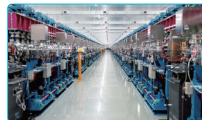
X線レーザーを生み出す真空封止型アンジュレータ
