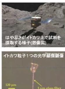
直径 < 100 μm の粒子中の鉱物の種類や形状を非破壊で計測
